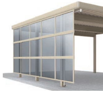
本体(丸柱・桁300):SK / 破風(スタンダード):SK / 折板厚:0.6mm(ヘフ無し) / オプション:ポリカ折板
