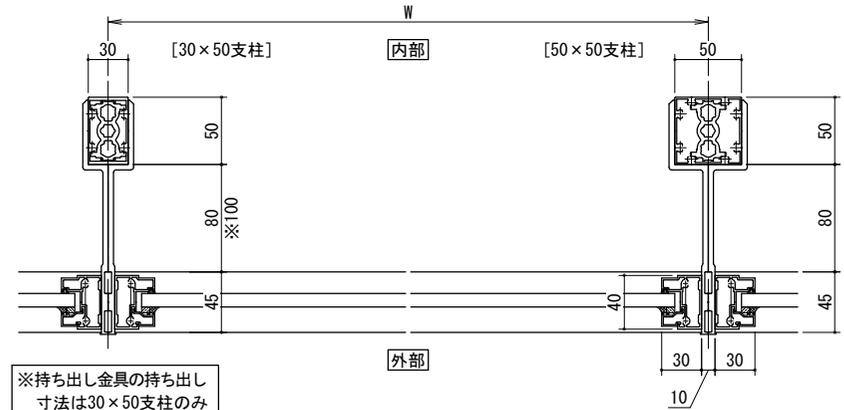
※持ち出し金具の持ち出し寸法は30×50支柱のみ80mmと100mmの対応が可能です。
