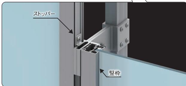
縦枠がスライドする構造のため、室内側からのガラス取り付け作業が効率的に行えます。さらにガラスの脱落を防止するストッパー機構を備えており、安全性にも配慮した設計です。
