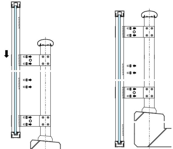
⑤ ガラスユニットを仮固定している六角ボルトを取り外し、ガラスユニットを下げ降ろす。
